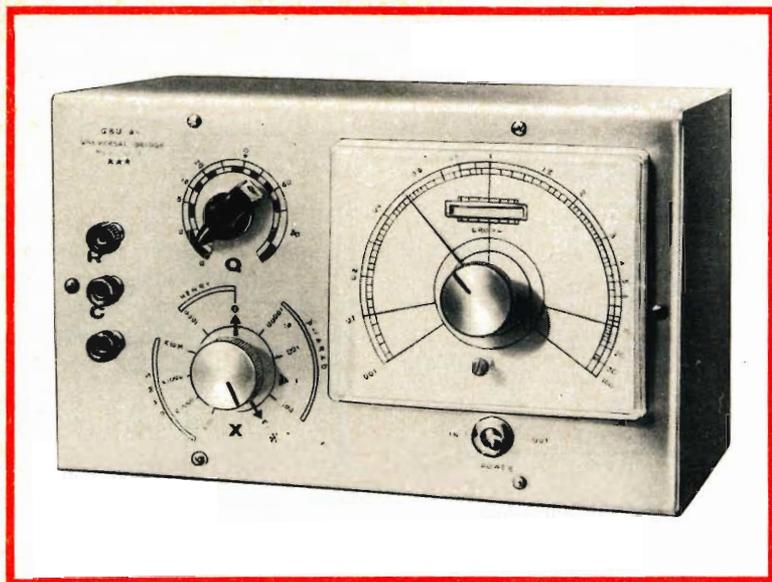
Fig. 4 - Disposizione dei comandi nel ponte R.C.L.
